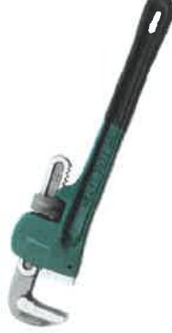
名称：管钳 功能：用于装卸水管；
